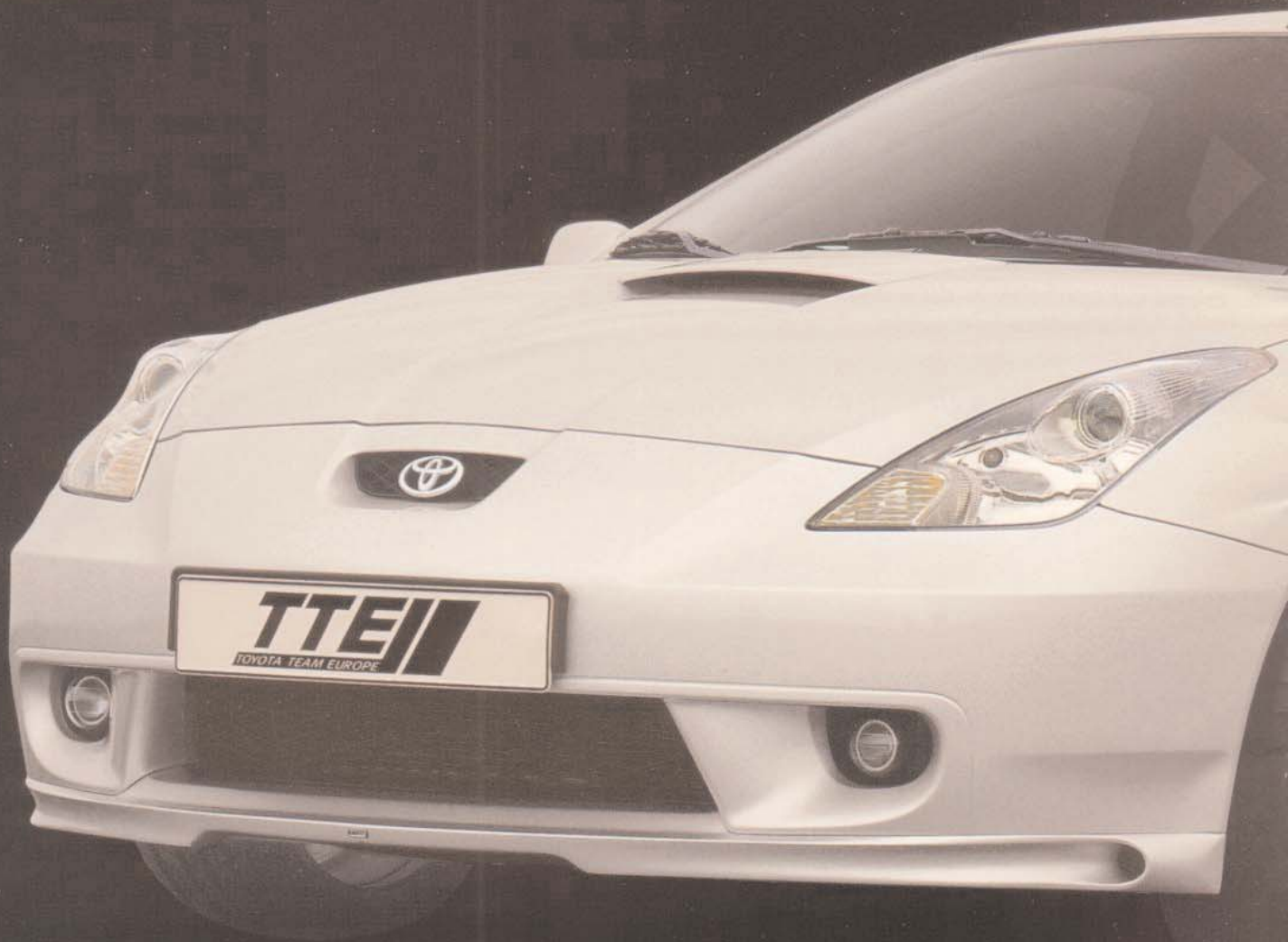
TTE Frontspoilerlippe mit zusätzlichen Lufteinlässen: für verbesserte Aerodynamik . . . (44)
