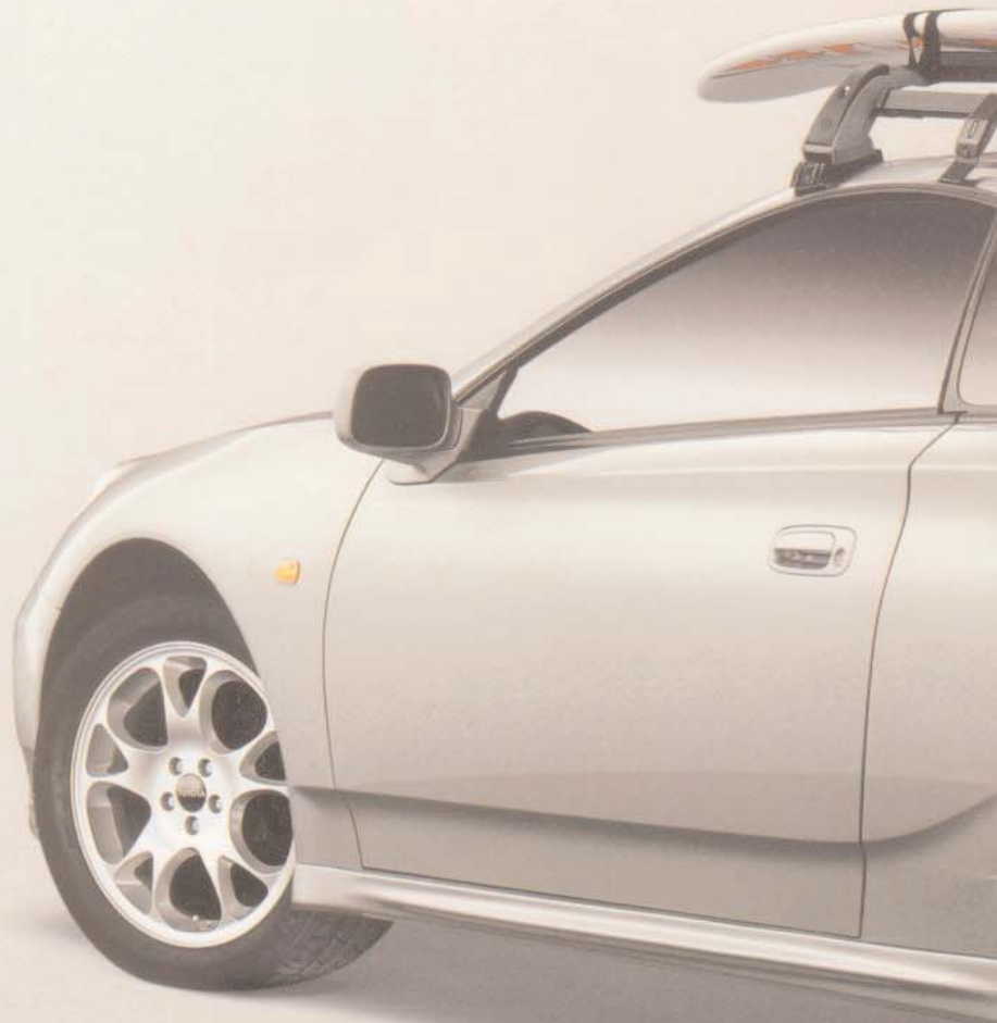
Abschließbarer Basisträger mit 50 kg Traglast . . . (12)
